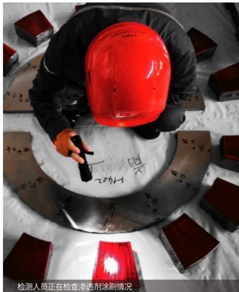
检测人员正在检查渗透剂涂刷情况
