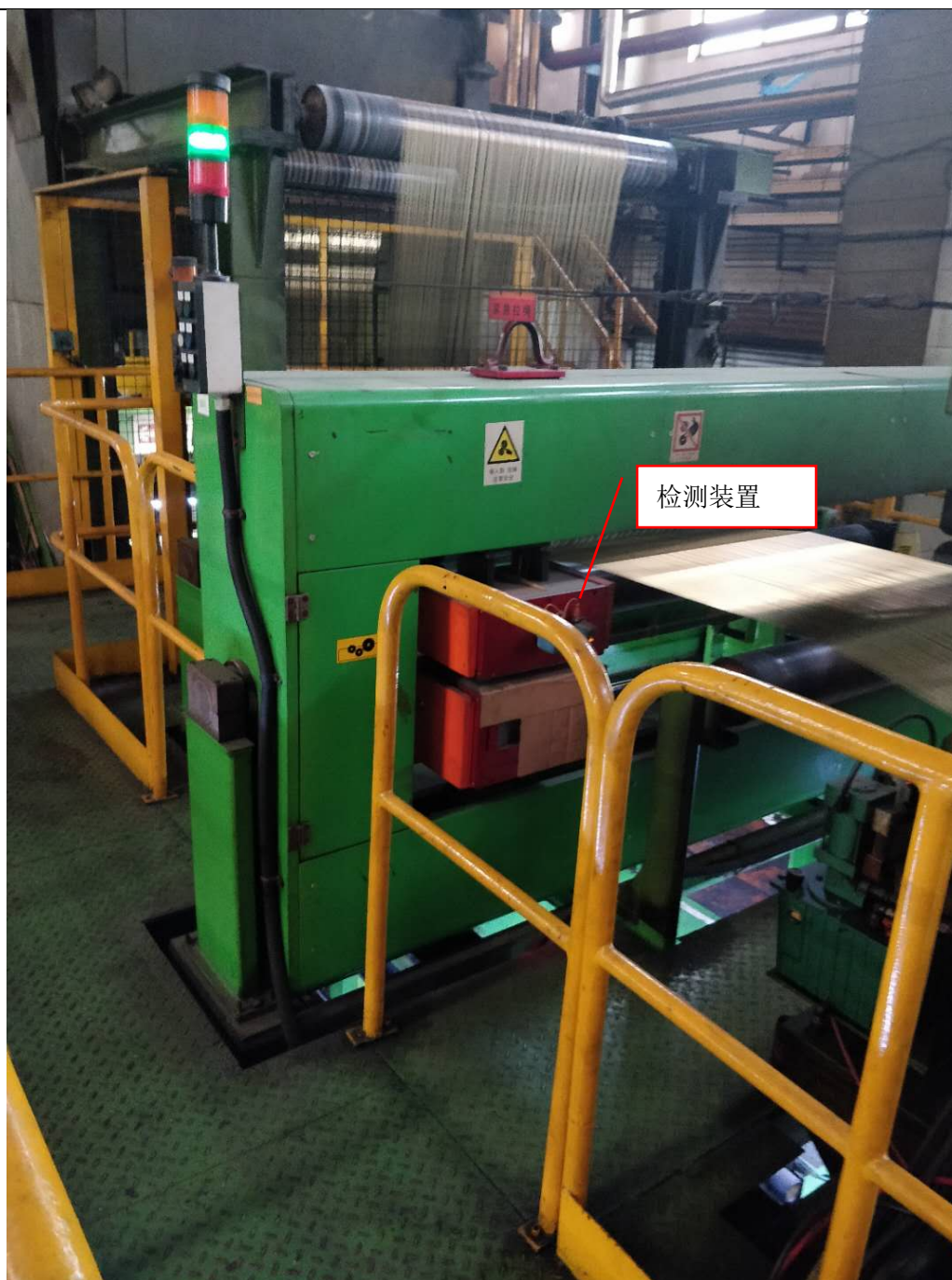
图 6-1 检测装置工作状态指示灯及警戒围栏
