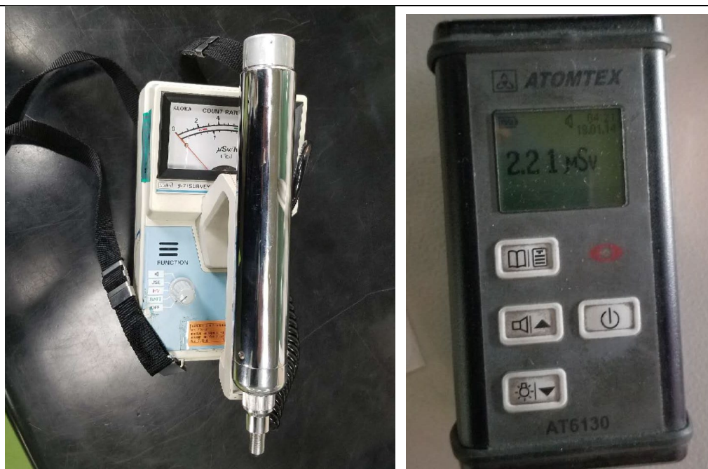
图 6-4 公司配备的巡检仪和报警仪
