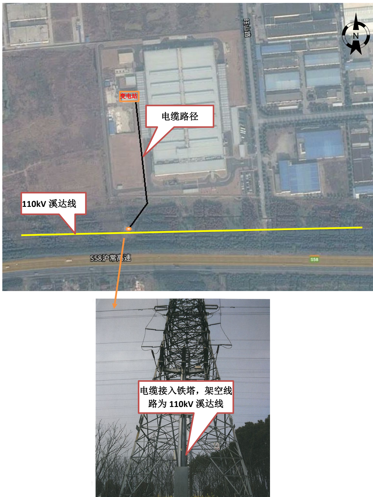
图 4-4 地下电缆路径图及接入点
