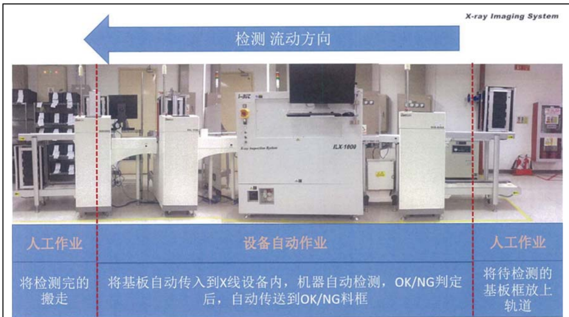
图 9-2 ILX1000 型 X 射线检测装置工作流程示意图
