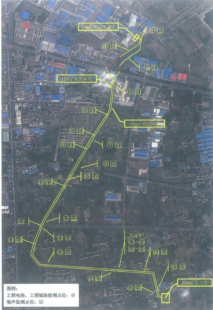
图 4 架空线路沿线断面检测布点示意图
