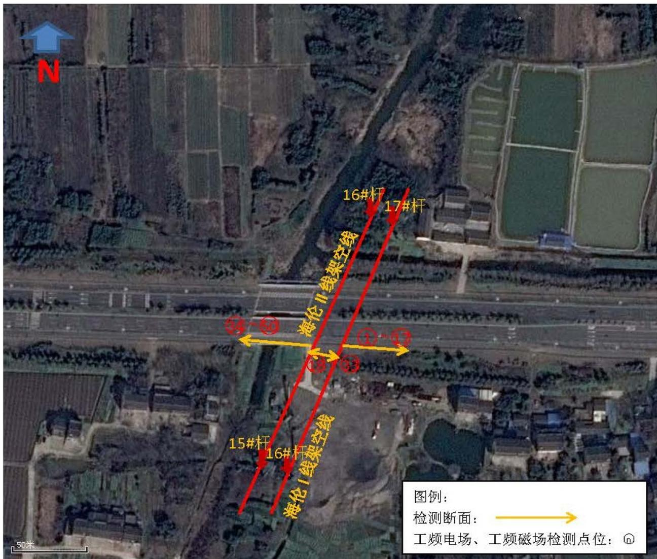
图 10 架空线路下方断面检测布点示意图
