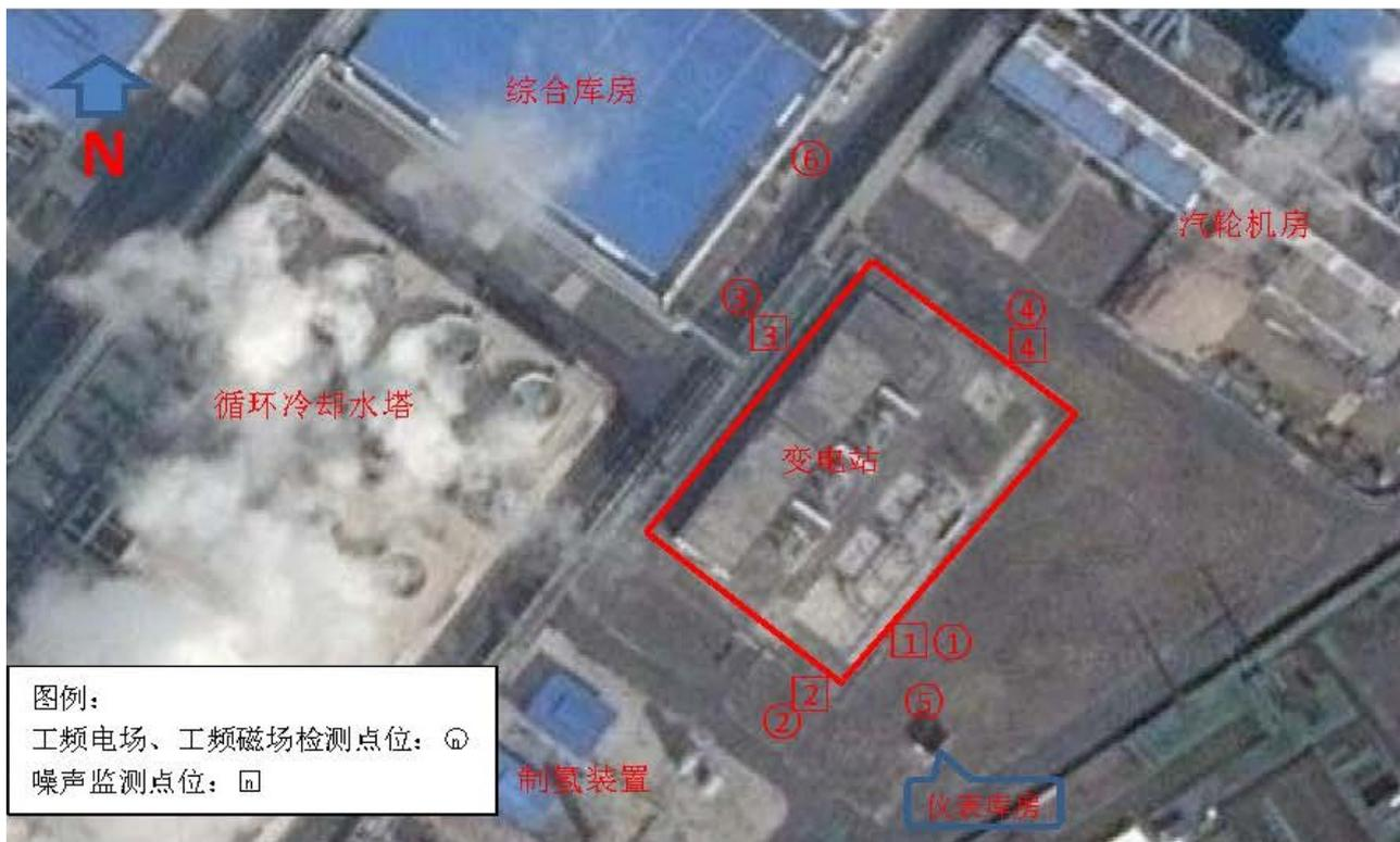
图 8 变电站周围检测布点示意图
