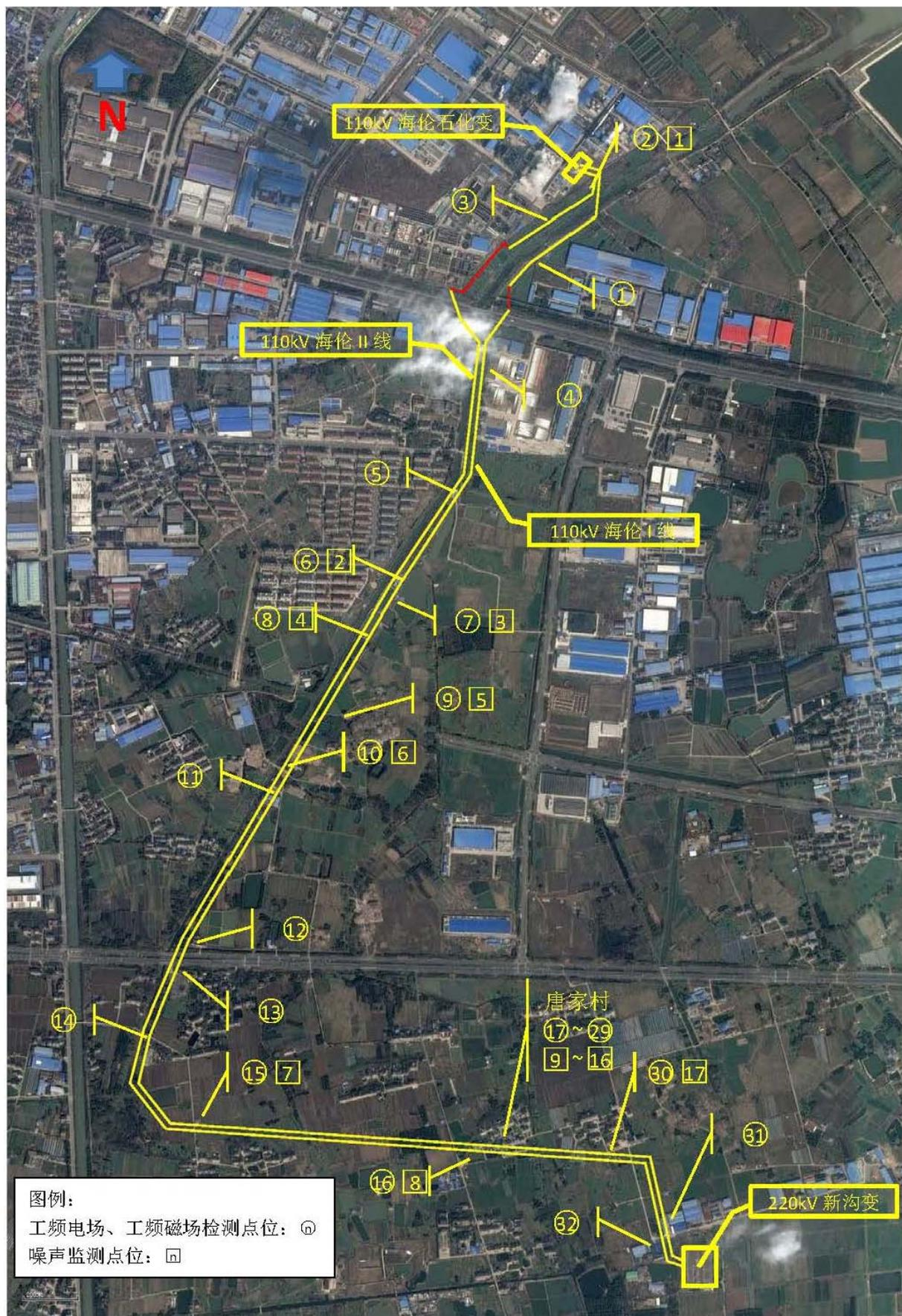
图 11 架空线路沿线检测布点示意图
