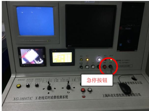
图 3-8 X 射线实时成像装置急停按钮
