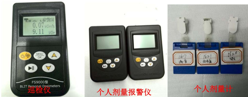
图 3-9 辐射监测仪器 (巡检仪、个人剂量报警仪、个人剂量计)
