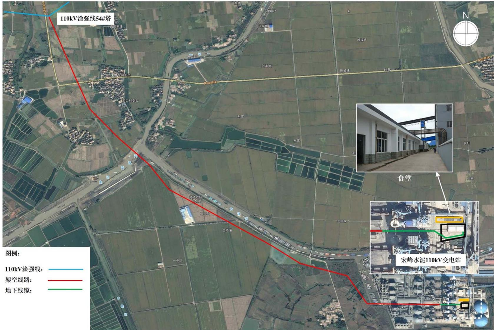
图 5 宏峰水泥 110kV 变电站及配套线路工程线路路径图
