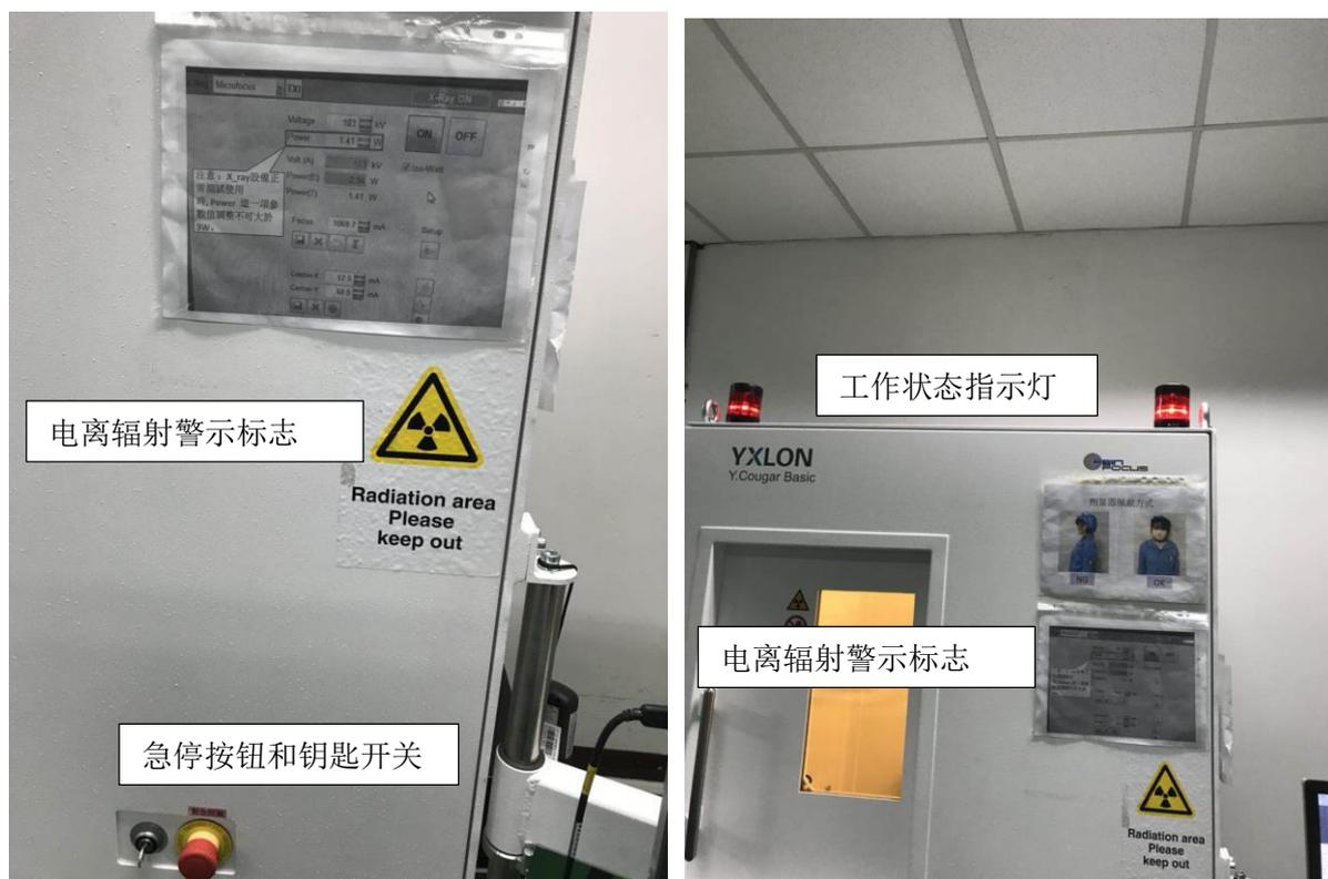
图 5-1 电离辐射警示标志、急停按钮、工作状态指示灯
