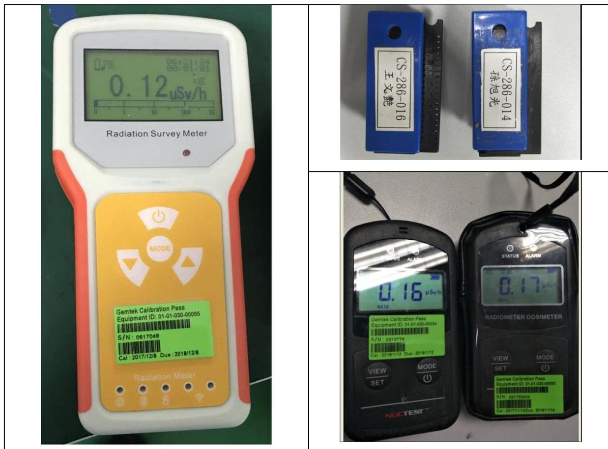
图 5-2 个人剂量报警仪、巡检仪和个人剂量计
